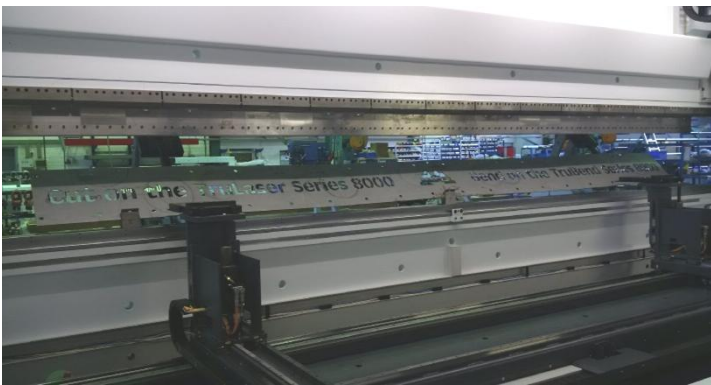
Biegen des 6 m langen Musterteils
