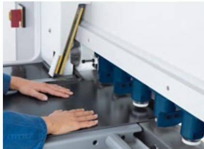
Der Lichtvorhang macht das Einlegen kleiner und schmaler Blechstreifen besonders einfach und sicher.
