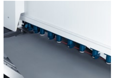
Mit dem Schnittlinienlaser schneiden Sie auch auf Anriss sicher.
